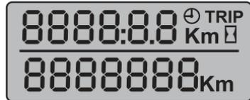
O display informa o hodômetro total, o hodômetro parcial, o relógio e o horímetro. A linha superior é composta por 6 dígitos, ponto decimal, vírgula e símbolos auxiliares ("relógio", "trip", "km" e "ampulheta").
