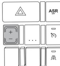
Para programar uma determinada rotação, pressione constantemente o interruptor, com o sinal “+”.
