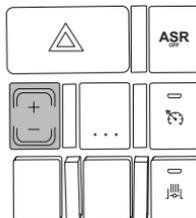
O seu veículo sai de fábrica com a marcha lenta regulada a 700 rpm. De acordo com a necessidade, a marcha lenta poderá ser alterada, acionando-se o interruptor “+ / -” no painel de instrumentos.
