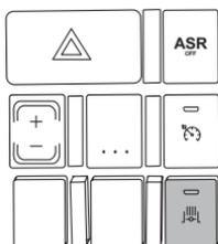
O freio-motor atuará sempre que o interruptor estiver acionado, o motor estiver em uma rotação superior a 1000 rpm e os pedais do acelerador e da embreagem estiverem liberados. Exceto quando a PTO estiver em funcionamento.
