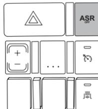
Para **desativar** o controle automático de tração, acione o interruptor no painel. A luz indicadora no painel ASR acende-se, indicando que o sistema foi desativado.
