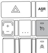
Para ativar a função de controle automático de velocidade, acione o interruptor, no painel do seu veículo, para a posição LIGADO.
