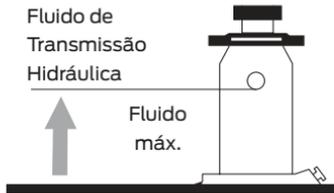
O macaco terá pleno funcionamento se o nível do fluido estiver na borda inferior da sede do bujão de inspeção e abastecimento.
