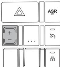
Para programar uma determinada velocidade, acelere o veículo até a velocidade desejada e pressione o lado com o sinal “+” do interruptor.
